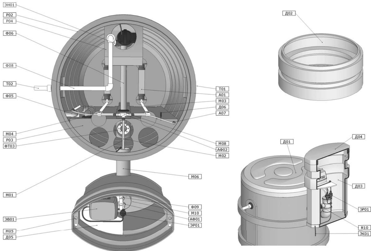
Рисунок 1.2. Принципиальная схема ААТ
