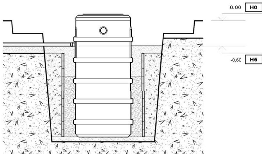
Рисунок 2.9. Засыпка песка, монтаж технологического канала, при монтаже ААТ АНА 080.
