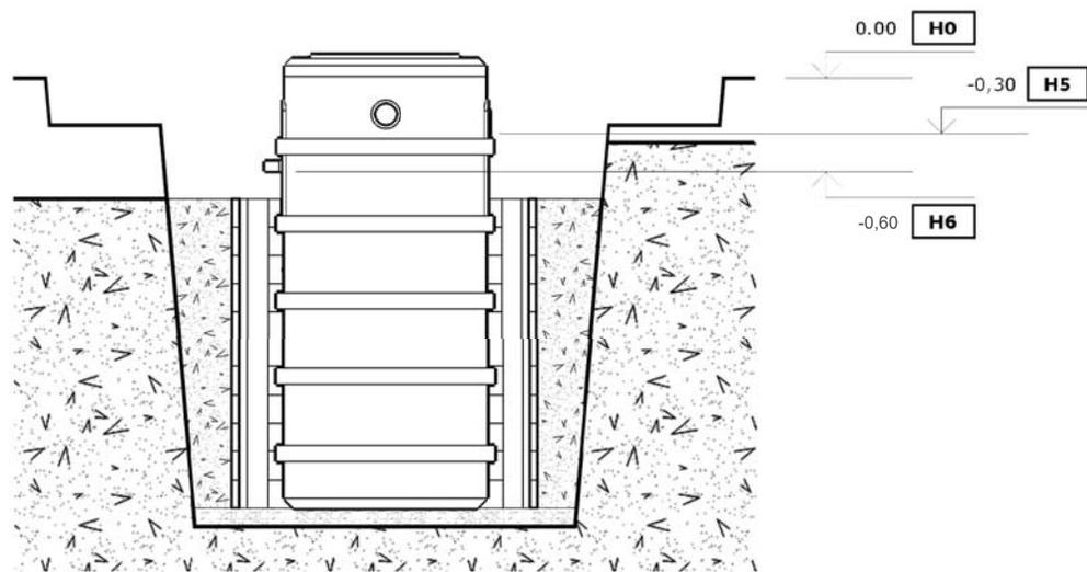
Рисунок 2.7. Засыпка ЦПС при монтаже ААТ АНА 080.
