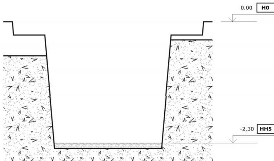
Рисунок 2.5. Установка опалубки в котловане для монтажа ААТ АНА 080.
