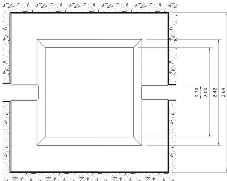
Рисунок 2.3.2. Чертеж котлована для установки ААТ АНА 080. Разрез.
